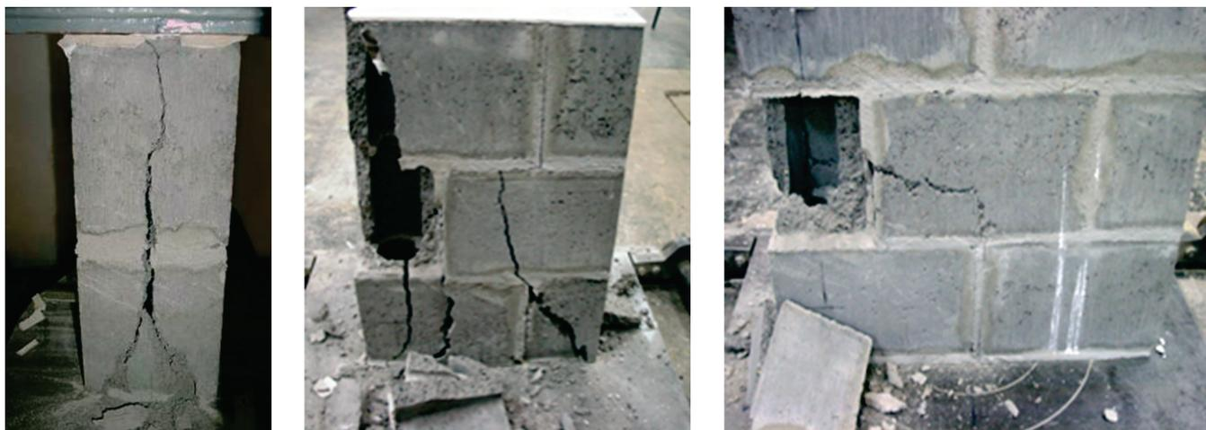
**Figura 11 - Forma de ruptura dos prismas armados**
