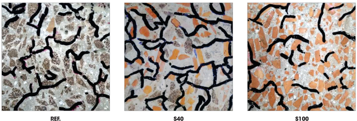
Figura 4 Corpos de prova após ensaio de lascamento explosivo (temperatura: 925^\circ\text{C} )
