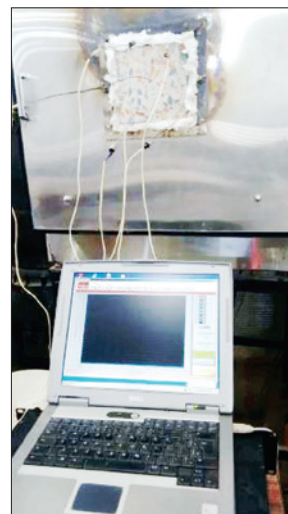
Figura 1b Amostra posicionada para ensaio de lascamento ( spalling )
